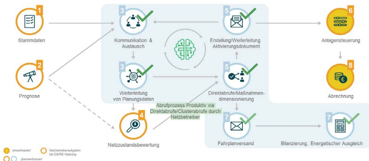
Abbildung 3: Funktionsweise des Redispatches über die DA/RE-Plattform
